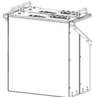
Montaggio a parete attraverso il kit Wall Mount (max. 2 batterie)
